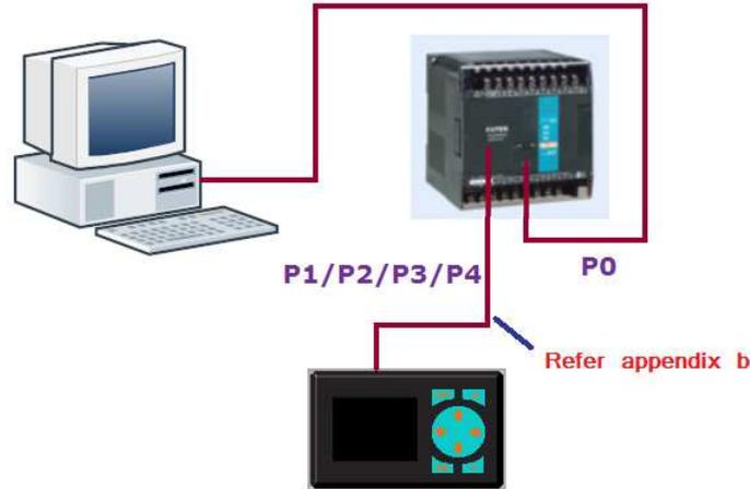
方法 2 – 利用 PLC 的 port0(mini Din 接頭)通訊埠與簡易參數設定器(PEP)連接.此接法可利用本公司隨 PEP 產品提供的 FBs-232P0-MD-200CM 標準通訊線或參考附件 a 的圖來自行製作.電腦端可接 PLC 的 port1, port2, port3 或 port4 的任一埠.
